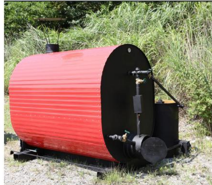
特願No.2025-42198 ロケットストーブを用いた間接加熱式炭化装置 2025/03/17特許出願 受領済
